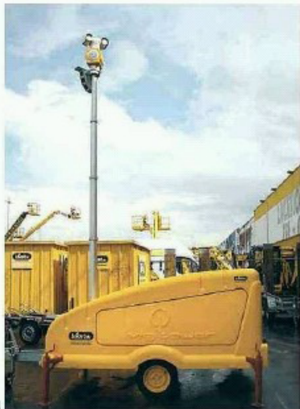
« Vigitower » permet de surveiller en temps réel une zone extérieure temporaire comme un chantier, une manifestation, etc.
